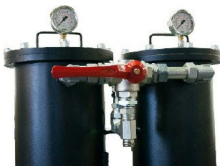
Poignée à gauche - filtre gauche alimenté
