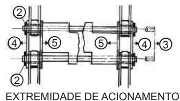
Para remover a correia da carcaça, retire a correia na direção indicada na Fig. 10.
